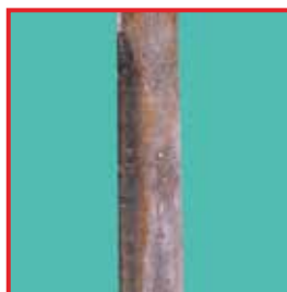
Штамп костевой, поверхность скольжения шибера со следами коррозии
