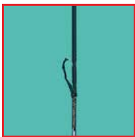
Нарушенная изоляция ВЧ-инструмента
