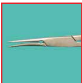
Деформация вследствие неправильного обращения
