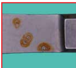
Деталь пинцета: Хлорсодержащая регенерационная соль вызвала массивную язвенную коррозию на поверхности инструмента. Причина: негерметичное подключение ионообменника в аппарате для мойки и дезинфекции (АМД).
