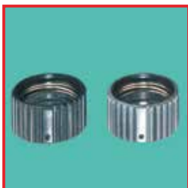
Изображение справа: повреждение материала умягченной водой.
