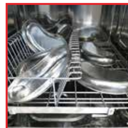
Неправильная загрузка/опрокинутые почкообразные лотки
