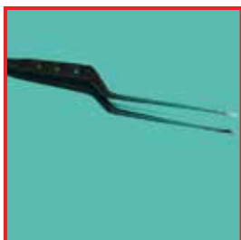
Деформация вследствие неправильного обращения
