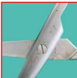
Ножницы с язвенной коррозией
