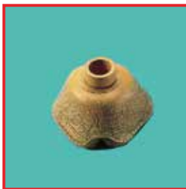
Трещины старения на респираторной маске
