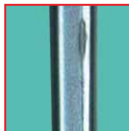
Контактная коррозия: нержавеющая сталь/латунь
