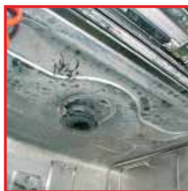
Промывная камера с сильной накипью
