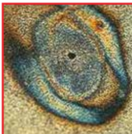
Пример язвенной коррозии
