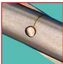
Трещины вследствие напряжений в зоне шарнира ножниц
