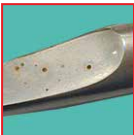
Язвенная коррозия инструмента под действием хлоридов.
